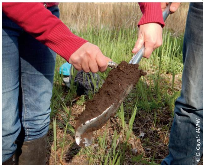
**d** Puis démoulez le prélèvement dans la gouttière graduée.
