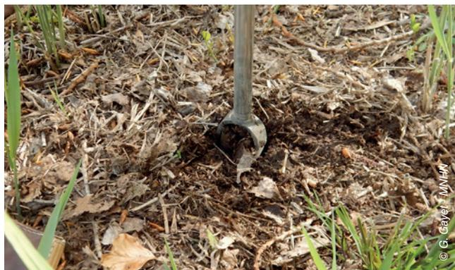
**c** Retirez la tarière du sol avec le prélèvement et nettoyez les contours du prélèvement en le raclant alors qu'il est encore dans la tarière.
