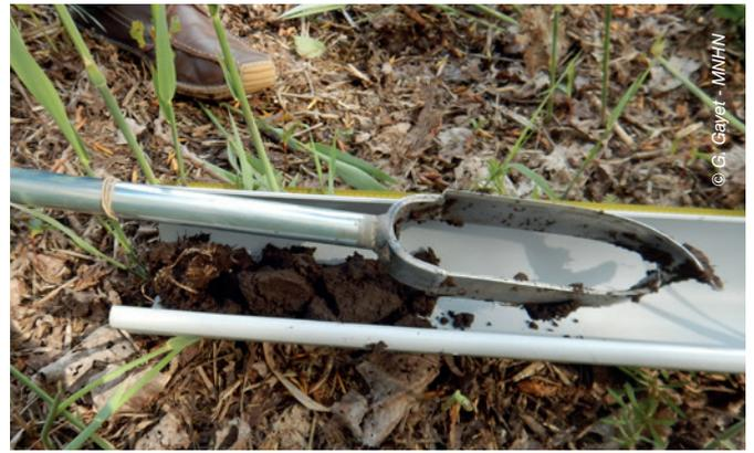
Matérialisez la profondeur à laquelle vous souhaitez réaliser le prochain sondage avec un élastique sur la barre de la tarière. Cela évite de réaliser le prochain prélèvement à une trop grande profondeur et de tasser le prélèvement.
