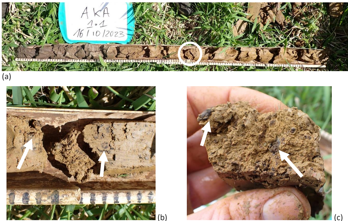
Figure 108 : Reconstitution d'un profil pédologique réalisé en Guadeloupe (a, la surface du profil est à gauche), dans une zone humide rétro-littorale (Les Abymes). Le lieu des photos en macro est indiqué par un cercle blanc en (a) et les nodules noirs ferromanganiques sont indiqués par des flèches blanches en (b) et en (c).
